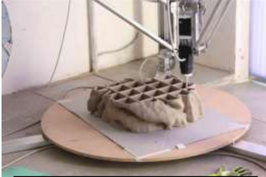
شكل 22: الطباعة ثلاثية الأبعاد لوحدة خزفية
