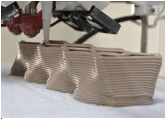
شكل 18: أحد الوحدات أثناء الطباعة الثلاثية الأبعاد
